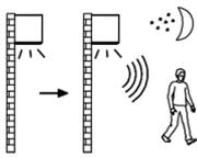
Die Lampe hält bei 5% Helligkeit 20 Stunden, der Sensor löst sich 180 Mal bei 100% Helligkeit für jeweils 30 Sekunden aus.
