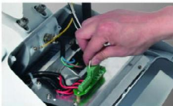
Die Steckerverbindungen für die Lichtquelle, Stromzugang und Außendrähte sind leicht zu handhaben.
