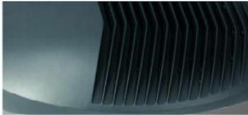
Die Oberseite des Gehäuses in V-Form ergibt eine ideale Wärmeableitung und verhindert, dass Schmutz und Vogelkot haften bleiben.
